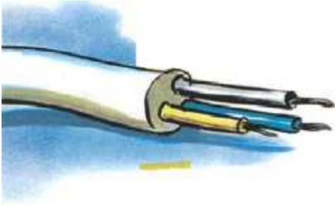
**14** Cuando un receptor (electrodoméstico, máquina, etc) le dé "calambre", es porque hay derivación de corriente de los hilos conductores o en algún elemento metálico del electrodoméstico. Normalmente se Dispara el Diferencial. Localizar el aparato o parte de la instalación donde se produce y aislar debidamente al
