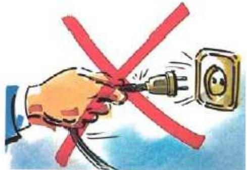
**16** No se puede enchufar cualquier aparato en cualquier toma de corriente. Cada aparato tiene su potencia. Como cada toma de corriente tiene la suya. Vea la 'Instalación Interior de su vivienda o local' de esta Guía y adecúe los aparatos a enchufar con las tomas. Si la potencia del Aparato es superior a los Amperios que permite enchufar la toma de corriente, puede quemarse la base del enchufe, la clavija e incluso la instalación.
